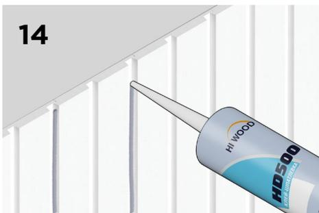
При установке белых панелей стыки, погрешности можно обработать клеем-шпатлевкой HD500.
