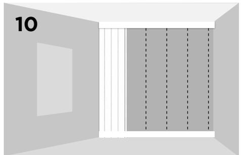
Устанавливаем панели согласно заранее подготовленной разметке. Чаще всего установка производится от угла помещения
