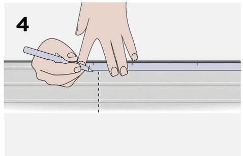
Нанесите линии разреза на обратной стороне панелей. Если вы планируете использовать карнизы и плинтусы HIWOOD, то необходимо учитывать их размеры при разметке линий разреза на панелях.
