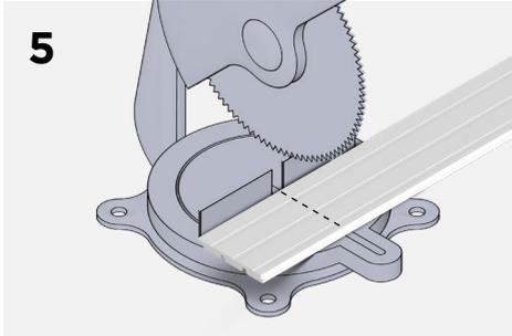
Производим запил длины панели на торцовочной пиле или стусле.
