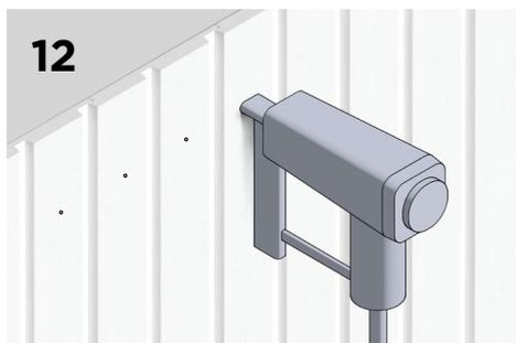
Допускается дополнительная фиксация строительными шпильками.
