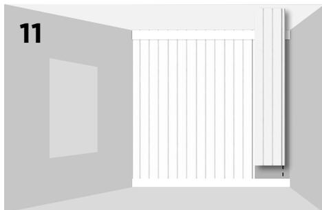
Устанавливаем следующие заранее подготовленные панели по принципу шип-паз
