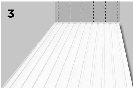
Разложите панели и финишные молдинги на полу вдоль стены на которую планируется монтаж для проверки правильности замеров.
